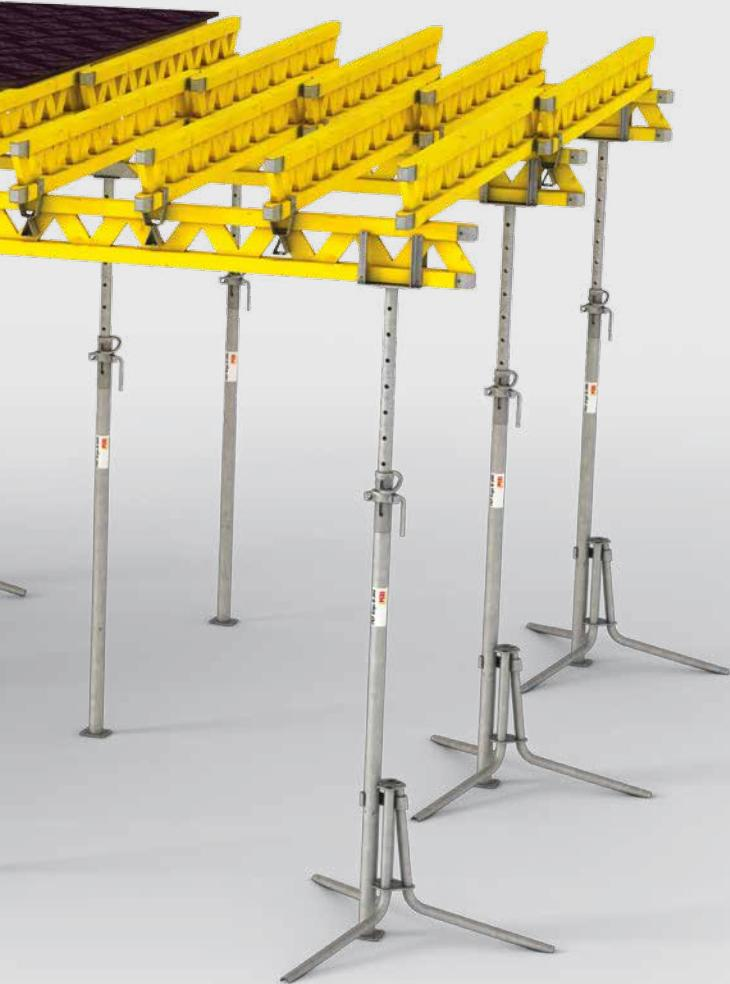
На изображении представлен пример системы с балками-фермами GT 24 в качестве продольных и поперечных балок. Как вариант, могут использоваться балки VT 20K или комбинация обеих балок. Для повышенных нагрузок также возможно использование узлов, состоящих из двух параллельных балок, размещенных, как сдвоенные продольные балки.
