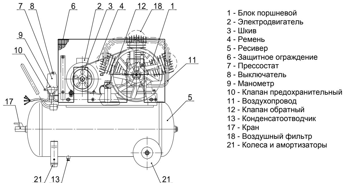
Рисунок 4 - Общий вид компрессора СБ4/Ф-100.ЛВ75
