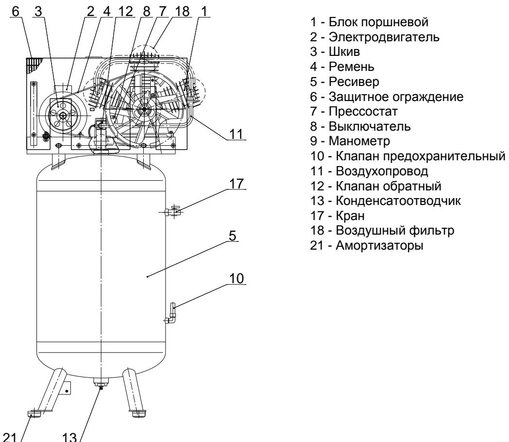
Рисунок 6 - Общий вид компрессора СБ4/Ф-270.LB75В
