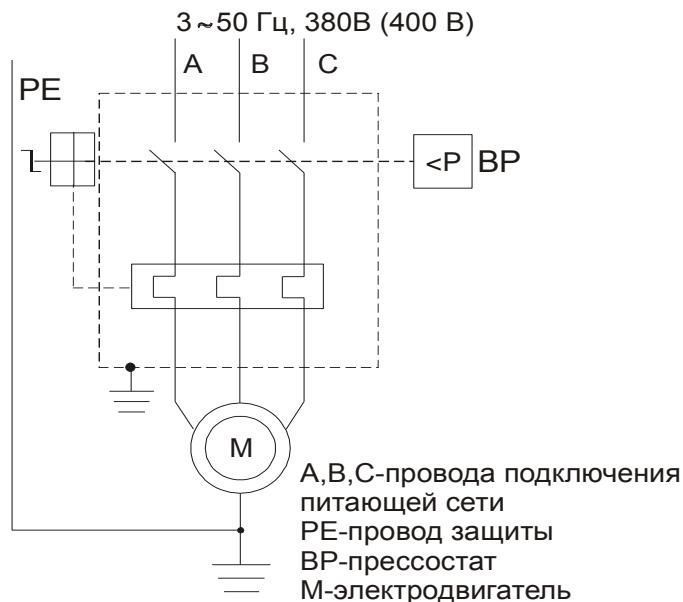
Рисунок А.1 - Схема электрическая принципиальная компрессоров СБ4/С-100.LB75, СБ4/Ф-270.LB75, СБ4/Ф-270.LB75B, СБ4/Ф-500.LB75
