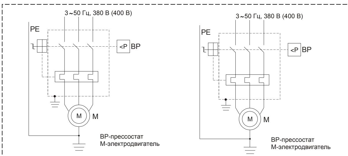
Рисунок А.2 – Схема электрическая принципиальная компрессора СБ4/Ф-500.LB75ТБ
